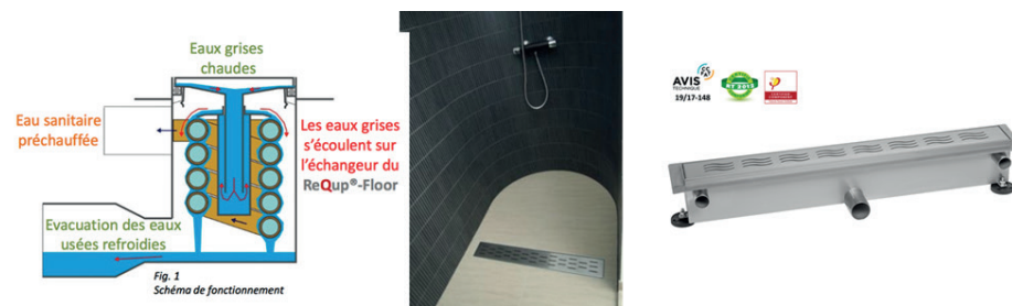
Figure 111 : Système RecupFloor® de Gaïa Green sous avis technique CSTB
