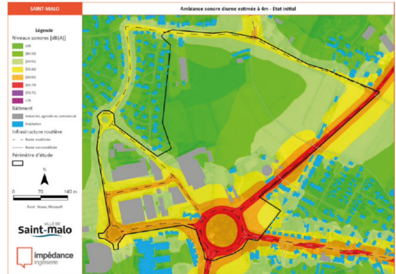
Carte des niveaux sonores diurnes calculés à 4m du sol en situation initiale 2022
