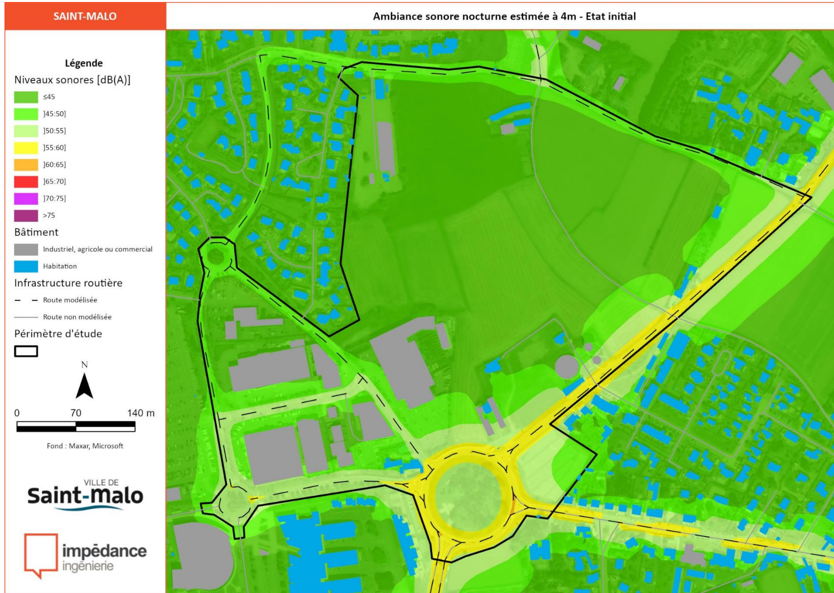
Carte des niveaux sonores nocturnes calculés à 4m du sol en situation initiale 2022.
